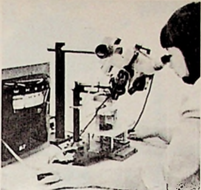
Het monteren van de IC in een behuizing met semi-automatische apparatuur. Het plakje wordt aan de randen opgepakt om beschadiging van het oppervlak te voorkomen. (Transitron)
